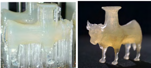
Une réplique du taureau fabriquée par la machine de stéréolithographie SLA 500 en sortie de cuve et après nettoyage et suppression des barbules puis durcissement au four UV.
